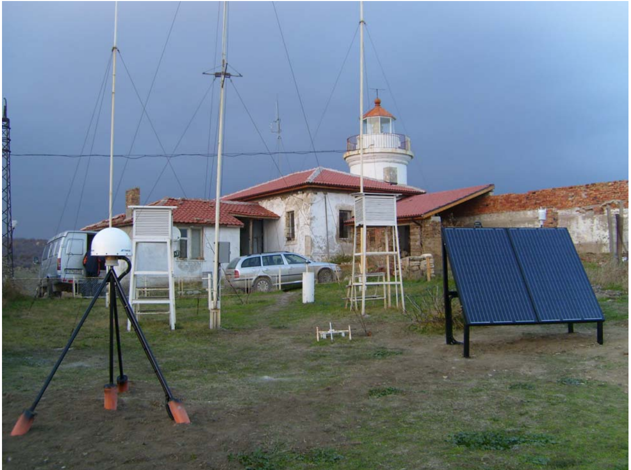
Фото 1. Инсталиран приемник със захранващите слънчеви панели на нос Емине
